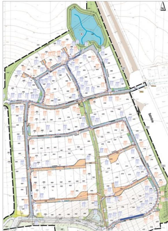
entwässert. Die „Mulde Nord“ ist als Regenrückhaltebecken in Form eines Erdbeckens geplant. Es wird mit einer ortstypischen Wiesenmischung eingesät. Die Mulde nimmt das komplette Regenwasser des nördlichen Teils des Baugebietes auf. Über ein Drosselbauwerk wird das Wasser in die Mulde 2 Süd eingeleitet.
