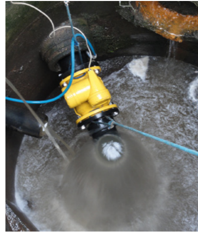
24_Abflussermittlung zur Fremdwasserreduzierung
